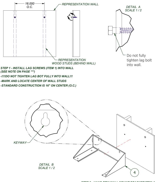
STEP 2 - HANG RTW WALL MOUNT BRACKET(ITEM 4) OVER LAG BOLTS-SLIDE DOWN INTO KEYWAY
